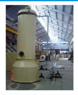
TANK WITH TOWER AND PUMP BEING TESTED IN FACTORY
